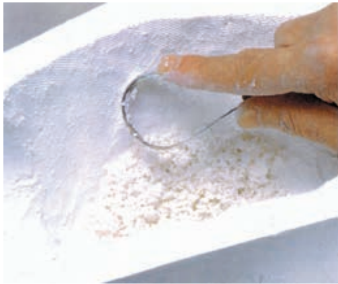
۱۸- قبل از آن که گچ به طور کامل سفت شود با تیغه ای کمّانی شکل و دندانه دار، سطوح ناخواسته را بتراشید.
