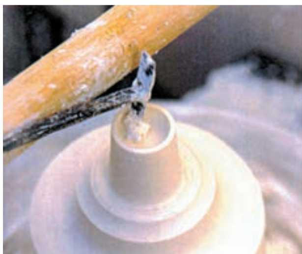
۸- تراش داخلی با استفاده از تکیه‌گاه
