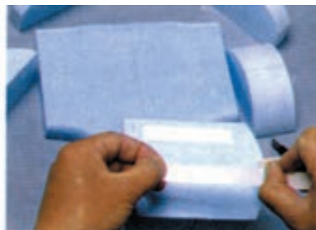
۱- برش قطعات از پیش طراحی شده از بلوفوم
