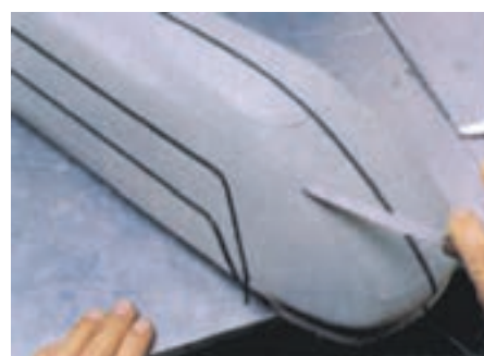
۸- با قرار دادن یک صفحه رنگی، پنجره‌های مدل ساخته شده است.
