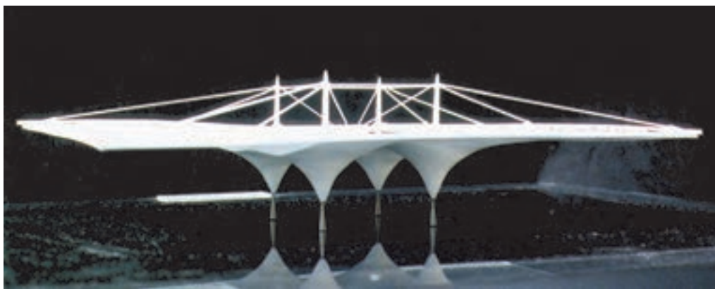
شکل ۳۲- مدل پوسته‌ای با فایبرگلاس
