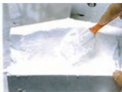
۱۶- گچ را درون قالب یک دست کنید.
