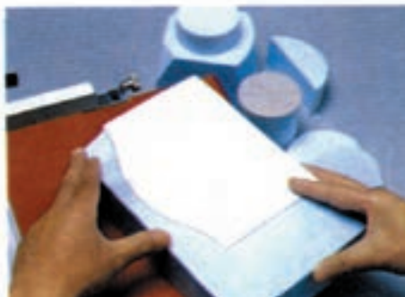
۲- مونتاژ قطعات فومی ساخته شده
