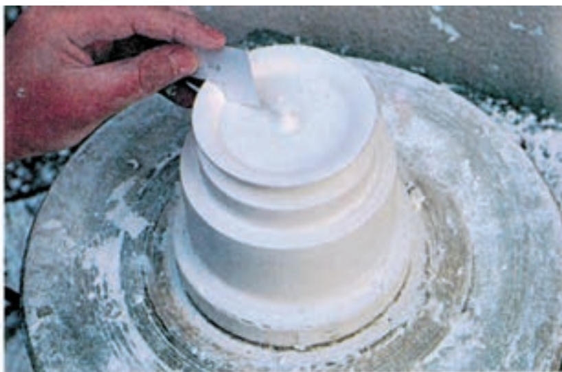
۱۵- ایجاد انحنا - میزان انحنای لبه کار با شابلون بررسی می شود.
