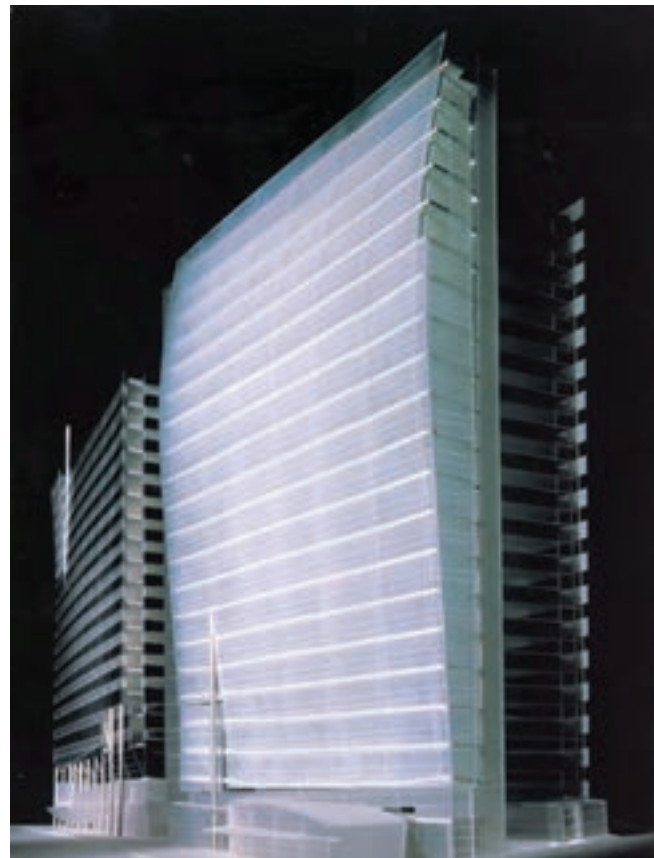
شکل ۳۳- ماکت‌های ساخته شده با آکرلیک (پلکسی گلس)
