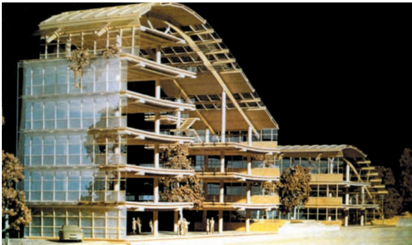
شکل ۳- ماکت یک فضای مسکونی - ساخته شده با قطعات P.V.C و پلکسی گلس
