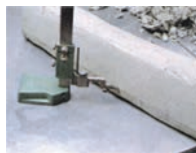
۶- در این تصویر، رخ مدل به وسیله ابزار پرداخت نهایی و کار می‌شود.
